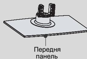
Під час монтажу підставки уважно прослідкуйте за тим, щоб правильно розрізнити та встановити передній та задній бік підставки.
