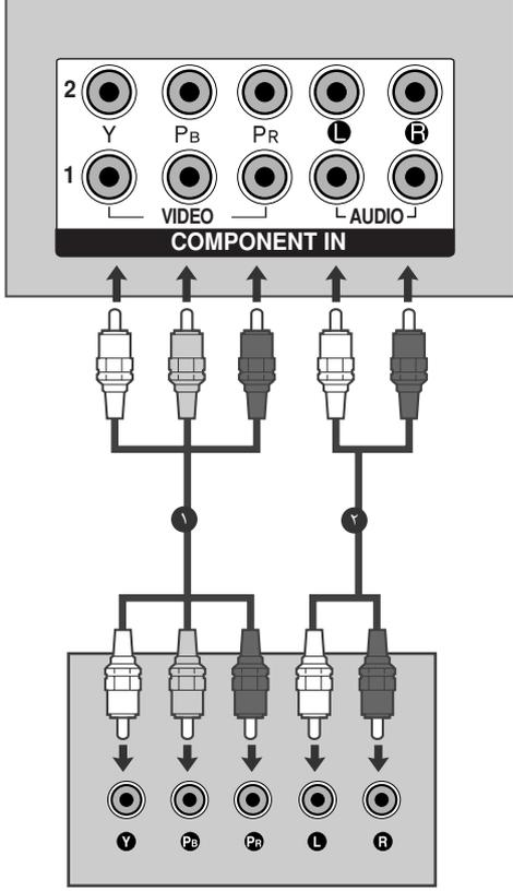
١ صل مخارج الفيديو (PR, PB, Y) الخاصة بمشغل أقراص الفيديو الرقمية بقوابس **COMPONENT IN VIDEO** مكون الفيديو (PR, PB, Y) في الجهاز.
