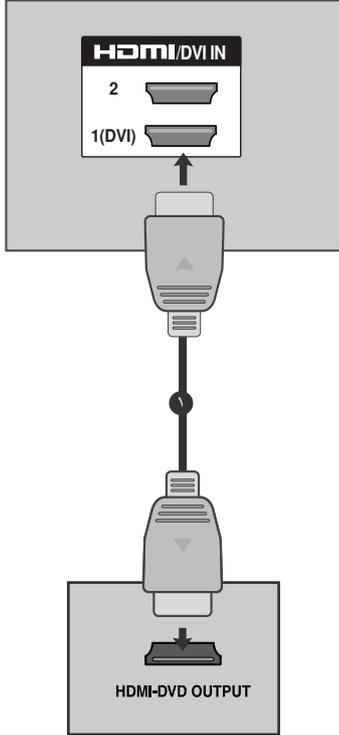
١ قم بتوصيل خرج HDMI الخاص بـ DVD (أقرص الفيديو الرقمية) بقابس تركيب الحامل الخاص بالطراز 19/22/26/32/37/42LH20\*\* الخاص بالطراز HDMI IN3(19/22LU5\*\*\*, 32/42LF2\*\*\*, HDM/DVI IN1, HDMI IN2(19/22LH2\*\*\* الخاص بالطراز في الجهاز.
