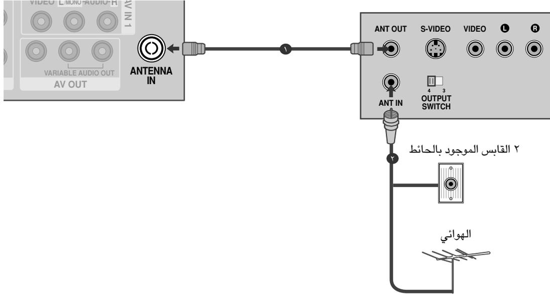
١ صل مقبس **ANT OUT** (خرج هوائي) جهاز الفيديو بمقبس **ANTENNA IN** (الهوائي) في الجهاز.
