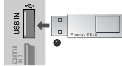
١ قم بتوصيل جهاز USB بمقبس USB IN الموجود في التلفاز.
