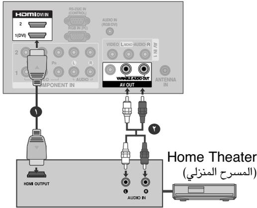
١ وصل طرف 1 HDMI/DVI أو (تركيب الحامل الخاص بالطراز HDM 2(19/22LH2\*\*\* أو (تركيب الحامل الخاص بالطراز (19/22LU5\*\*\*, 32/42LF2\*\*\*, 19/22/26/32/37/42LH20\*\* على الجانب الخلفي للتلفزيون وطرف خرج قنطف للمسرح المنزلي باستخدام كابلات HDMI.
