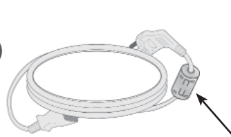
Феритове осердя (Цей елемент включено не до всіх моделей.)
