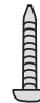
1-Гвинт для фіксації підставки (Тільки 26LG31**, 26LU50**, 32/37/42LF25**, 32/37/42LG2**, 32/37/42LG33**, 26/32/37/42LN20**, 26/32LD3**, 32/37/42LN3**, 32/37/42LN40**, 32/37/42LN49**, 32/37/42LN50**, 32/37LN70**, 42LN90**, 32/42LF51**) (Див. стор.8)
