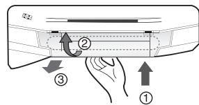
Снимите крышку лампы, потянув ее на себя ①.
