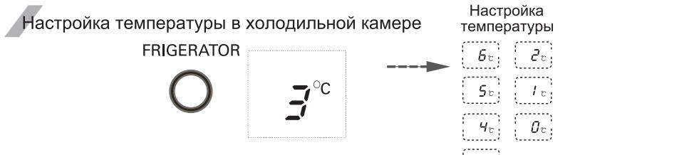
※ При нажатии на кнопку значения температуры меняются в следующем порядке  $(3^{\circ}\text{C} \rightarrow 2^{\circ}\text{C} \cdots \rightarrow 0^{\circ}\text{C} \rightarrow 6^{\circ}\text{C} \cdots \rightarrow 3^{\circ}\text{C})$ .
