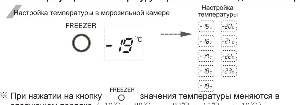
※ При нажатии на кнопку значения температуры меняются в следующем порядке  $(-19^{\circ}\text{C} \rightarrow -20^{\circ}\text{C} \cdots \rightarrow -23^{\circ}\text{C} \rightarrow -15^{\circ}\text{C} \cdots \rightarrow -19^{\circ}\text{C})$ .
