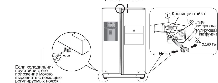
не затягивайте чрезмерно сильно, иначе можно испортить штифт. (Высота регулирования: максимум 5 мм).
