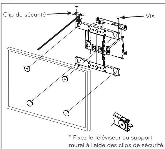
1. Installez le téléviseur muni des entretoises sur le support fixé au mur dans le sens de la flèche. Alignez d'abord la partie inférieure, puis soulevez légèrement le téléviseur pour aligner la partie supérieure.
