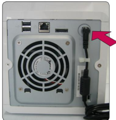
Una vez que el adaptador de corriente esté conectado al enchufe DC, conecte el cable de energía a una toma eléctrica.
