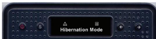
El modo de ahorro de energía apaga todos los servicios de NAS y minimiza la energía usada en todos los sistemas incluyendo el HDD para operar el NAS en el modo de máximo ahorro de energía. En este modo, todos los siguientes íconos desaparecerán.
