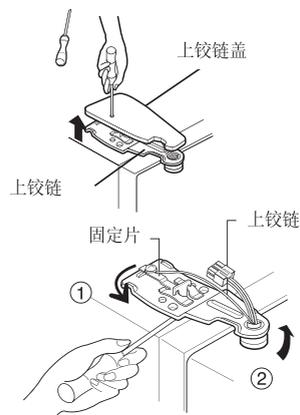
2) 将固定片的螺丝以逆时针方向转起(①)，即可将上铰链抬起(②)。
