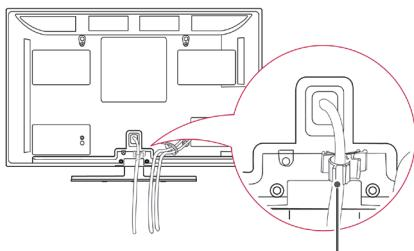
фиксатор кабеля питания
