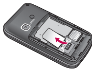
Para extraer la tarjeta USIM
