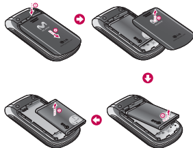
Para poner la tarjeta SIM Para quitar la tarjeta SIM
