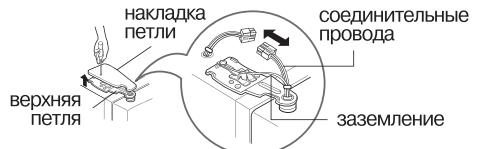
2) Снимите держатель, поворачивая его по часовой стрелке (①), а затем поднимите верхнюю петлю (②).
