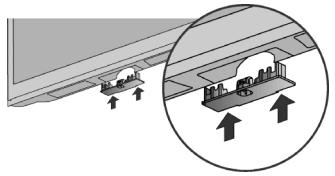
将保护盖安装到底座安装处的孔中,直到听到“嗒”的声音。
