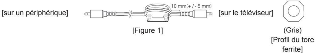
2 Utilisez un tore ferrite pour diminuer l'interférence électromagnétique du câble d'alimentation. Enroulez le câble audio autour du tore ferrite. Placez le tore ferrite à proximité du téléviseur et d'une prise murale.
