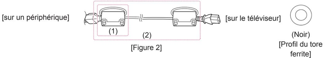
3 Utilisez un tore ferrite pour diminuer l'interférence électromagnétique du câble LAN. Enroulez le câble LAN autour du petit tore ferrite et trois fois autour du grand. Placez le tore ferrite à proximité du téléviseur.
