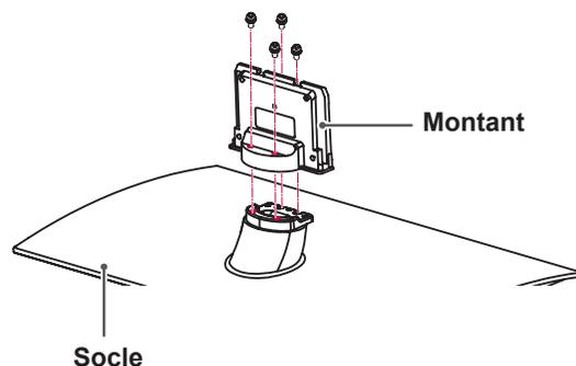
3 Fixez le socle au téléviseur à l'aide des 4 vis.
