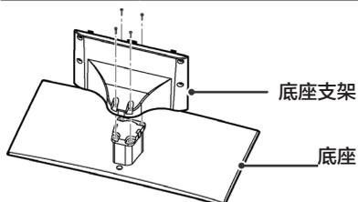
3. 将螺钉安装到电视机后盖上的孔中。
