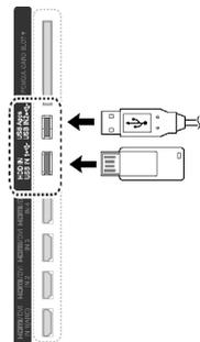
1. 将 USB 设备连接至位于电视机侧面的 USB IN1/HDD IN1 插孔里。
