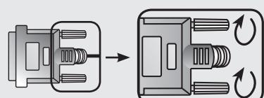
► Raccordez le câble d'entrée de signal et serrez-le en tournant dans le sens de la flèche comme illustré.
