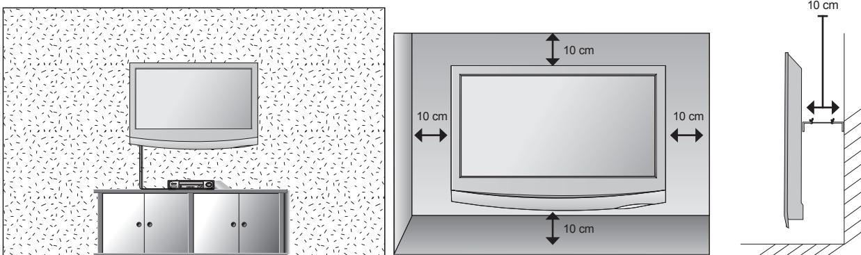
Si vous prévoyez d'installer l'ensemble sur un mur, fixez l'interface de montage mural (pièces en option) sur l'arrière de l'ensemble. Lorsque vous utilisez l'ensemble à l'aide de l'interface de montage mural (pièces en option), fixez-le soigneusement afin qu'il ne tombe pas.
