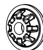
Rondelle d'espacement intérieure pour l'installation murale 4 EA (Selon les modèles) (Voir p.19)
