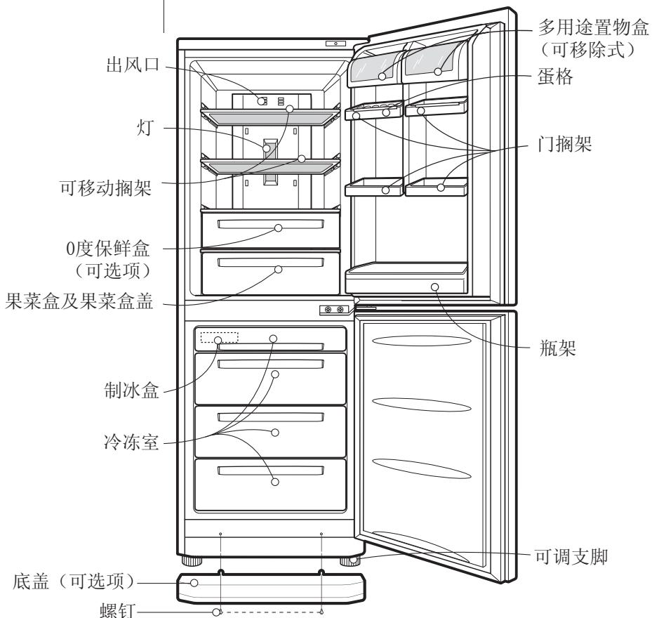
注：冰箱底盖出厂前是放在冷藏室搁架上的，当用户需要安装冰箱底盖时，请先卸下箱体下部螺钉，然后将底盖固定在箱体上。
