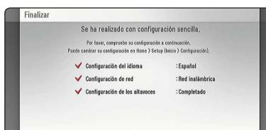
Pulse ENTER (◎) cuando [Finalizar] se ponga de relieve para finalizar las configuraciones iniciales. Si desea modificar una de las configuraciones, utilice </> para seleccionar [Anterior] y pulse ENTER (◎).
