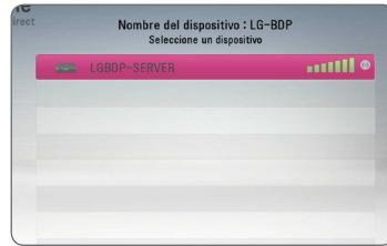
Si el dispositivo Wi-Fi Direct™ es compatible con el método de configuración Código PIN, basado en WPS (Configuración Wi-Fi protegida), seleccione un dispositivo en la lista y presione el botón de color amarillo (A). Note el número PIN en la pantalla. Y luego introduzca el número PIN en un menú de configuración del dispositivo a conectar.
