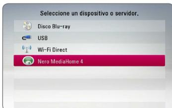
Para seleccionar un servidor de la lista de dispositivos, los archivos o carpetas deben estar compartidos con el servidor DLNA del dispositivo conectado.
