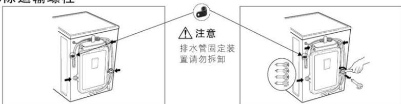
1. 为了防止运输途中的内部损坏,安装了4个螺栓,在使用洗衣机前沿着运输螺栓橡胶拆除这些螺栓。
