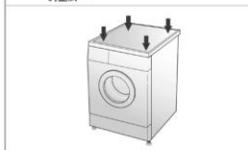
1. 调整洗衣机水平,可以防止额外的噪音和振动。将机器安装在结实且水平的地面上,最好在房间的角落。
