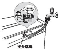
确保与进水阀连接的接头内有橡胶垫，并拧紧接头螺母后通水试机
