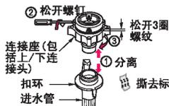
分离连接座和进水管，松开螺钉，下连接头松开3圈螺纹
