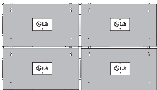
Σύνδεση συσκευής 4 με τις υπόλοιπες συσκευές (παράθεση 2 x 2)
