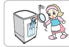
连接进水管，启动前请务必先打开水龙头确认是否漏水。
