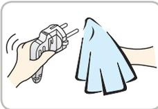
电源插头上沾有灰尘、水等时，请用干抹布擦拭，并重新插好电源插头。
