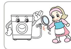
洗涤后必须关掉水龙头，洗涤前重新打开水龙头，确认水管连接完好。
