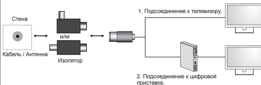
Подсоедините окончание изолятора к розетке кабеля/антенны, а другой его конец к телевизору или цифровой приставке.
