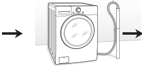
Conexión del tubo de desagüe
