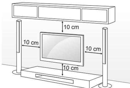
Asigurați-vă că utilizați șuruburi și console de montare pe perete care respectă standardul VESA. Dimensiunile standard pentru kiturile de montare pe perete sunt descrise în tabelul următor.
