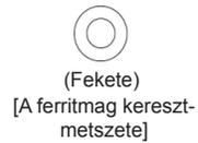
2 A kábel elektromágneses interferenciájának csökkentéséhez használja a ferritmagot. Helyezze a ferritmagot a tv-készülék közelébe.
