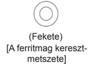
Tekerje fel egyszer a számítógép audiókábelét a ferritmagra.
