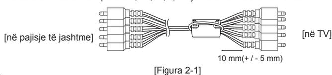
Mblidhni dhe lidhni komponent Y, Pb, Pr, L, R dhe kabllon scart me Bërthamë ferrite.
