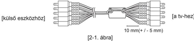
Fogja össze és szorítsa meg a Y, Pb, Pr, L, R komponens és scart kábelét a ferritmagra.
