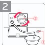
取下排水塞①,让水流出来,当再没有水流出来时,向左转动排水泵过滤器②,直到将其打开。
