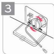
清除排水泵过滤器中的杂质。清洁完后顺时针转动排水泵过滤器,将排水泵塞插回原处,关上下盖。
