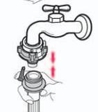
将进水管向上插入下连接座，保证扣环位于下连接座卡槽内。
