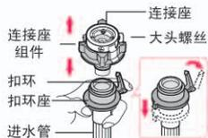
一手拿着连接座组件，一手按住扣环往下拉，将连接座组件与进水管分开。
