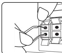
Подсоедините контакт каждого черного провода к клемме с маркировкой – (минус), а другой контакт — к клемме с маркировкой + (плюс).
