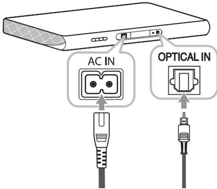
4. Другой разъем оптического кабеля подключите к телевизору.
