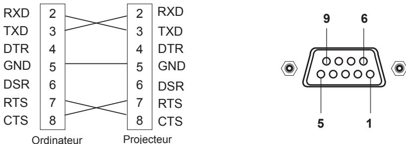
<Figure 1, diagramme de connexion RS-232>
