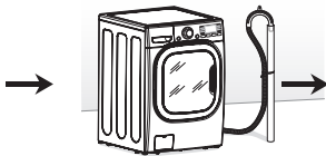
Raccordement de la conduite d'évacuation
