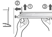
Поднимите ящик, держа его за обе стороны, а затем выньте в направлении ②.
