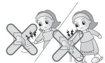
Удалите воду или пыль из вилки и вставьте на место, при этом концы штырей должны быть плотно подключены.
