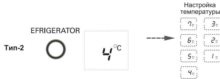
※ При нажатии на кнопку , настройки температуры будут меняться в следующей последовательности ( $3^{\circ}\text{C} \rightarrow 2^{\circ}\text{C} \dots \rightarrow 1^{\circ}\text{C} \rightarrow 7^{\circ}\text{C} \dots \rightarrow 3^{\circ}\text{C}$ ).
