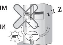
Заливайте в автоматическое устройство для приготовления льда только питьевую воду (только для моделей с раздаточным устройством).
