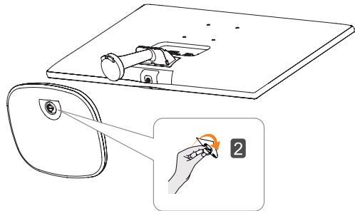
2 确认底座的正反面，然后将其安装在连接器上，用螺钉固定住。
