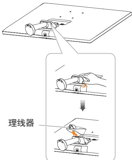
4 将支架上的两颗螺钉拧下。如图所示，将支架从连接器上拆下。
