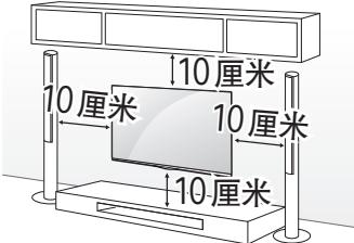
确保使用符合 VESA 标准的螺钉和挂架。下表中介绍了壁挂套件的标准尺寸。
