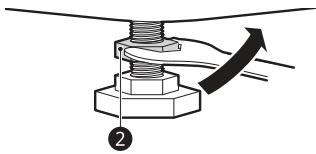
**4** Verifique si todas las tuercas de seguridad de la parte inferior de el electrodoméstico están aseguradas correctamente.
