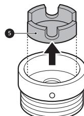
3 Presione el adaptador contra el extremo del grifo de modo que el sello de goma forme una conexión hermética. Ajuste los 4 tornillos de fijación y la placa anular del adaptador.
