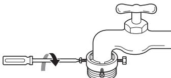
4 Presione la manguera de entrada ③ verticalmente hacia arriba de modo que el sello de goma de la manguera pueda adherirse completamente al grifo y luego ajústela girando la rosca hacia la derecha.
