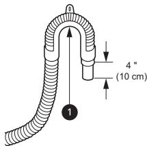
**2** Sostenga el extremo de la manguera de drenaje por encima del lateral de la tina de descarga.
