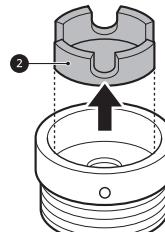
3 Presione el adaptador contra el extremo del grifo de modo que el sello de goma forme una conexión hermética. Ajuste los 4 tornillos de fijación.
