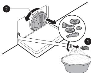
**4** Despues de la limpieza del filtro de la bomba de drenaje, reinserte cuidadosamente el filtro y
