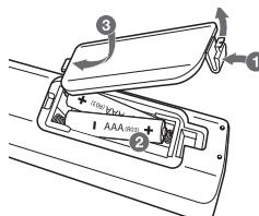
Retirez le couvercle du compartiment des piles à l'arrière de la télécommande, puis insérez deux piles R03 (AAA) en respectant la polarité + et -.
