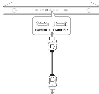
Vers la prise HDMI OUT de votre appareil (décodeur, récepteur satellite numérique, console de jeux vidéo, etc.)
