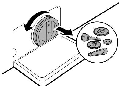
**5** Después de la limpieza del filtro de la bomba de drenaje, reinserте cuidadosamente el filtro y atornille la tapa de drenaje en el sentido de las agujas del reloj con cuidado para evitar daños a la rosca y fugas. Reinserte el tapón en el tubo de drenaje y coloque el tubo en su soporte.
