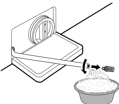
**4** Desatornille el filtro de la bomba de drenaje lentamente para vaciar el agua restante y luego proceda a eliminar cualesquier residuos u objetos del filtro.
