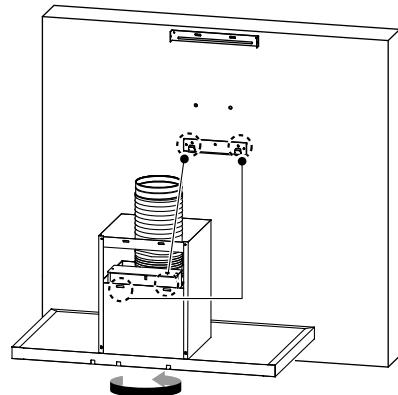
6 Luego de conectar el tubo de extracción con seguridad, fije el soporte fijación de la chimenea con 2 tornillos ① para prevenir que el electrodoméstico se deslice hacia abajo del soporte de fijación de la campana.
