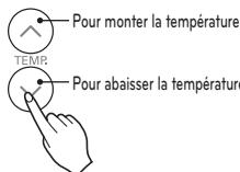
\* Plage de réglage de la température en mode chauffage : 16~30 °C (60 °F~86 °F)
