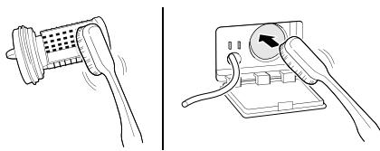
6 清洁排水泵过滤器后，小心地重新插入过滤器并顺时针拧紧排水盖，避免螺纹错扣和泄漏。
