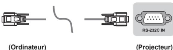
Figure 1 : diagramme de connexion RS-232
