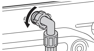
**2** Retirer le filtre d'arrivée d'eau avec une petite pince et nettoyer le filtre à l'aide d'une brosse à dents à poils medium.
