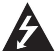
等边三角形内带有箭头符号的闪电符号旨在提醒用户，产品外壳内存在未绝缘的危险电压，其强度可能足以对人员构成触电风险。
