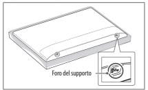
Se si collega al TV una staffa per montaggio a parete, inserire i distanziali per il montaggio a parete nei fori per montaggio a parete del TV per regolarne l'angolazione verticale. (Solo quando viene fornito l'elemento della forma seguente)
