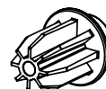
Separadores interiores para montaje en pared 4EA (Solo LA97**) (Consulte la página 21)
