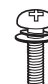
Parafusos do suporte 6EA, M5 x 16 (Apenas LA98**, LM96**) (Consulte a p. A-5)
