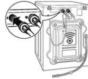
Raccordement de la conduite d'eau
