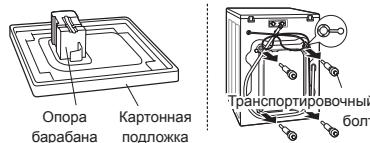
Снимите транспортировочные болты и опоры.
