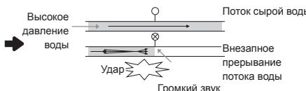
Отрегулируйте давление воды, прикрыв водяной клапан или кран.
