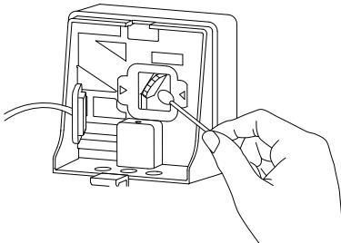
Apriete la tapa de goma, cierre la caja del Sensor PM1.0 y monte la cubierta de la esquina del Sensor PM1.0 en su posición original.
