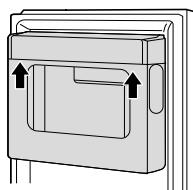
**3** Ensamble el cesto de la Puerta en el sentido inverso al proceso de extracción.
