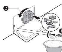
4 После очистки фильтра сливного насоса выньте его и вставьте сливную пробку.
